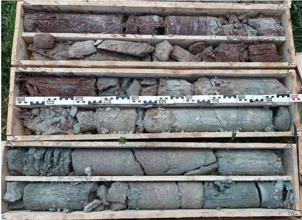
Foto Nr. 3: GWM 5 - Bohrkern 6 - 12 m
