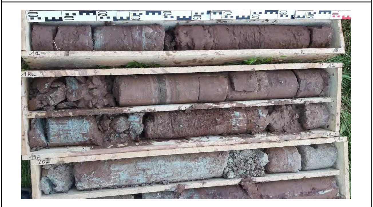
Foto Nr. 6: GWM 4 - Bohrkern 17 - 21 m
