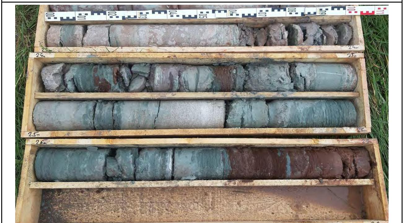
Foto Nr. 8: GWM 4 - Bohrkern 23 - 27 m
